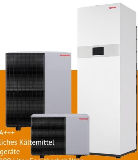
R290 Luft/Wasser Wärmepumpen im BiBloc-Design mit integriertem Warmwasserspeicher, für Vorlauf-Temperaturen bis +70°C, im Leistungsbereich von 4 bis 16 kW, zur Bereitung von Warm- oder Kaltwasser. Kombination von Außengerät und All-in-One Innengerät zur Versorgung aller Anwendungen wie Fancoils, Radiatoren oder Fußbodenheizung.
